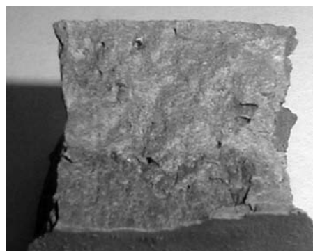
13. ábra. Különböző redukálószer-tartalmú cementek térfogatváltozása
