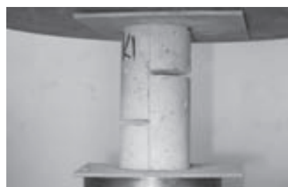
23. ábra Bemetszett, 60 mm átmérőjű henger nyíróvizsgálata Fig. 23. Shear test of a notched cylinder, diameter 60 mm
