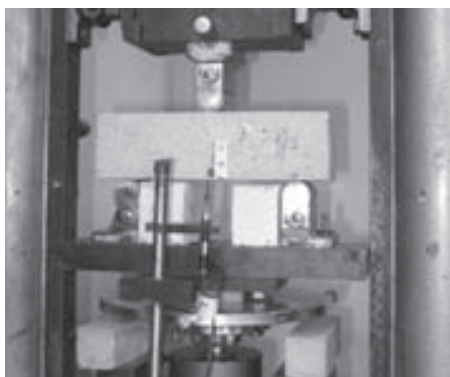
19. ábra Bemetszett, 70×70×250 mm élhosszúságú hasáb hajlító-húzóvizsgálata Fig. 19. Bending test of a notched beam, measure 70×70×250 mm
