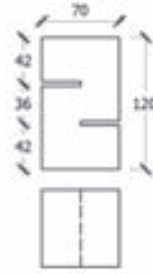
16. ábra Félbevágott, 70×70 mm alapú hasáb elvi kialakítása Fig. 16. Schematic shape of a half notched prism
