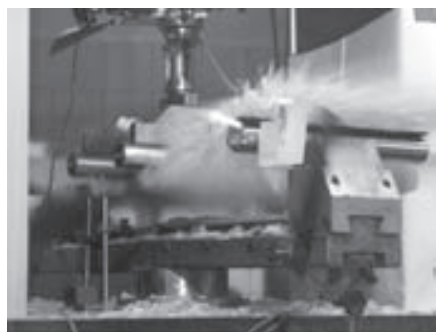
Fig. 6. Fracture of single tempered glass 6. ábra Egyrétegű edzett üveg törékenetetele
