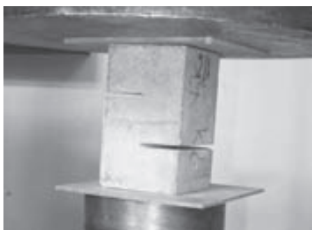
21. ábra Bemetszett, 70×70 mm alapú hasáb nyíróvizsgálata Fig. 21. Shear test of a 70×70 mm prism
